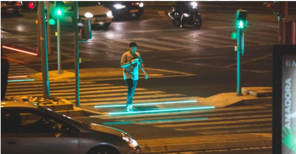
Figura 66 | *Smartcross*, implementado em algumas passadeiras na Amadora.
