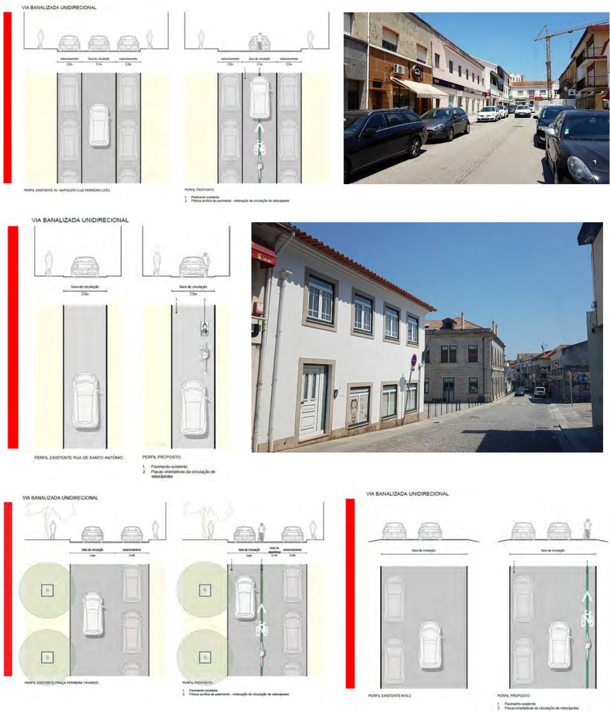
**Figura 12 – Perfis-Tipo: via banalizada unidireccional.
