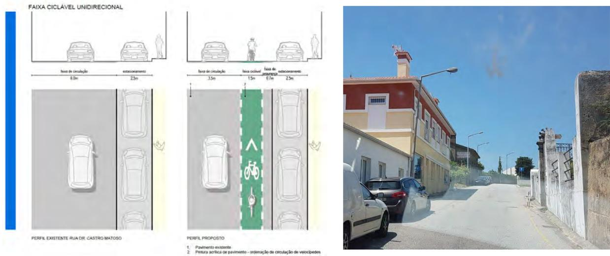
Figura 14 – Perfis-Tipo: faixa ciclável unidireccional.
