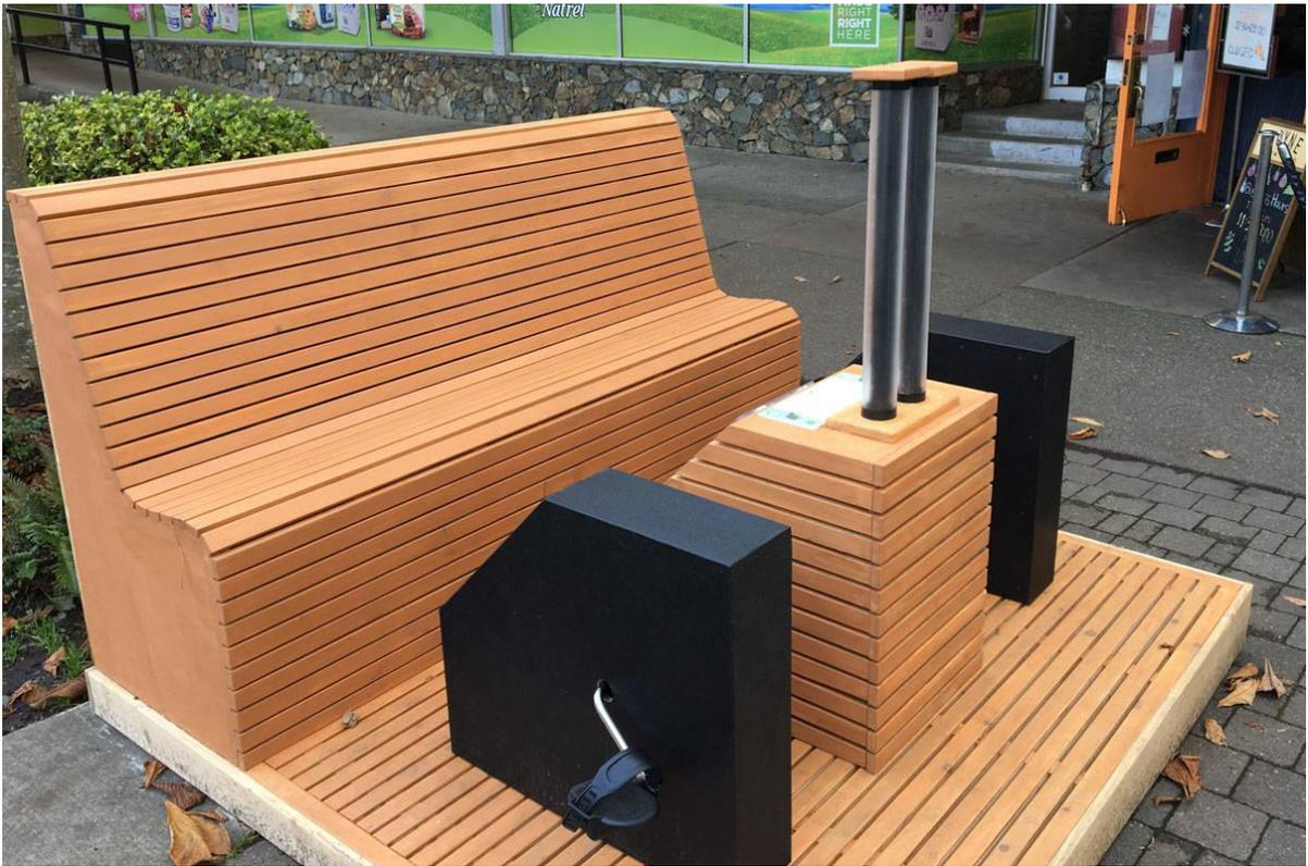
Figura 28 - Banco público com sistema de carregamento de baterias de telemóvel por via de pedais. Fonte: <https://www.vicnews.com/news/charge-your-phone-through-pedal-power-with-victoria-art-installation/>
